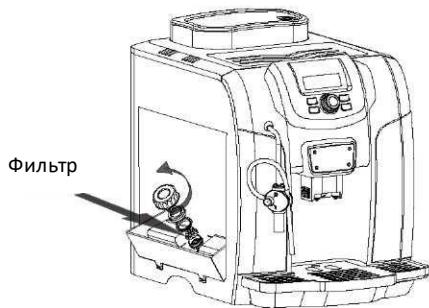
9. Поверните крышку против часовой стрелки, достаньте фильтр. После чистки установите на место.
