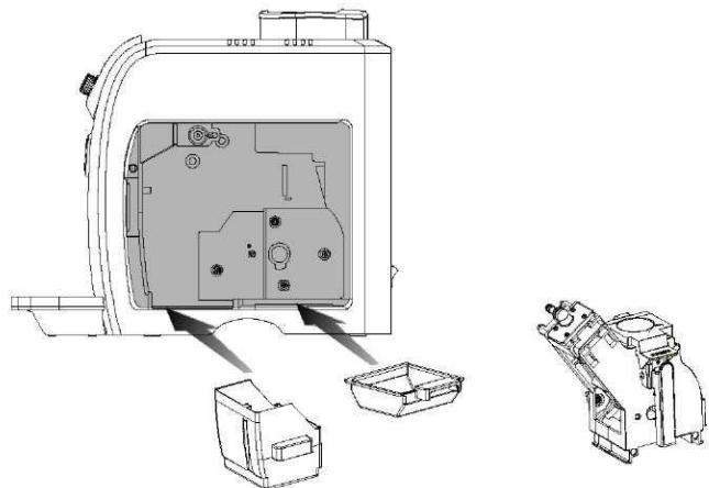
3. Достаньте бункер для отходов и лоток, почистите их при помощи неабразивного моющего средства.
