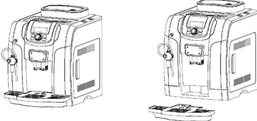
10. Проверьте красный поплавок, он не должен быть выше поверхности лотка для сбора воды. Достаньте лоток из машины и почистите. После чистки установить его на место.
