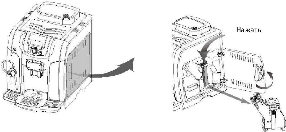
1. Отключите питание, извлеките вилку из розетки, затем откройте дверцу заварочного блока.
