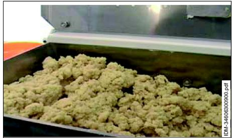
дежи. Это позволяет (при необходимости) откорректировать консистенцию теста, добавляя муку или жидкость, чтобы получить пригодное для экструзии тесто, имеющее рассыпчатый вид (см. рисунок выше). Цикл замеса длится приблизительно 8÷10 минут. Прибор возобновляет рабочий цикл только после опускания крышки и нажатия на кнопку **(G)**.
